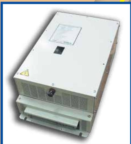
Статический преобразователь ПЧ-3 предназначен для преобразования напряжения постоянного тока, изменяющееся в диапазоне 40-310 В в напряжение 220 В, 50 Гц с однофазным или трехфазным выходом синусоидальной формы с обеспечением выходной мощности до 5,5 кВА. Преобразователь может использоваться для питания маломощных кондиционеров в кабинках машинистов локомотивов, электровозов, метро, а также для питания ответственных потребителей вагонов.
