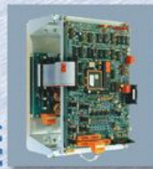
Инверторный модуль мощностью 3 кВт для питания вентилятора циркуляции
