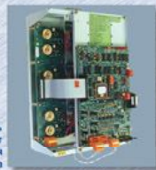
Инверторный модуль мощностью 18 кВт для питания двигателя кондиционера
