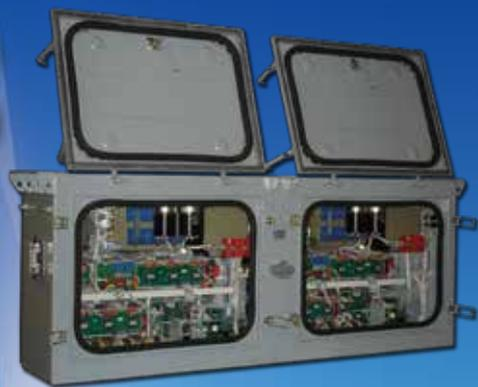
ПЧ-80-02М-У2 размещается в металлическом шкафу, который устанавливается в подвагонном пространстве. Охлаждение выполняется естественным отводом тепла с применением алюминиевых охладителей как при движении вагона, так и на стоянке. Преобразователь разработан с использованием современных технических, конструктивных решений на основе современной элементной базы, в том числе IGBT-транзисторов. Конструкция обеспечивает удобный доступ с лицевой стороны ко всем элементам и устройствам.
